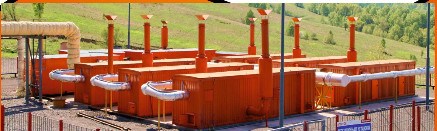
Модульные дегазационные установки МДУ-Р предназначены для откачивания метановоздушной смеси при проведении дегазации угольных пластов, выработанных пространств шахт и других источников метановыделения.
